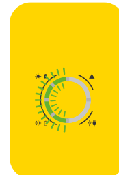
Knipperend: de temperatuur is te warm of te koud om op te laden (mogelijk bij 0-50 graden Celsius)
